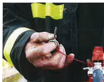
4) Estrarre e sbloccare la leva di intercettazione della spina di sicurezza
